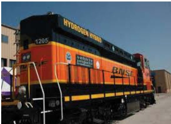
Figur 10: BNSFs hybridlokomotiv med brenselceller og batteridrift (Hess et al., 2010).
