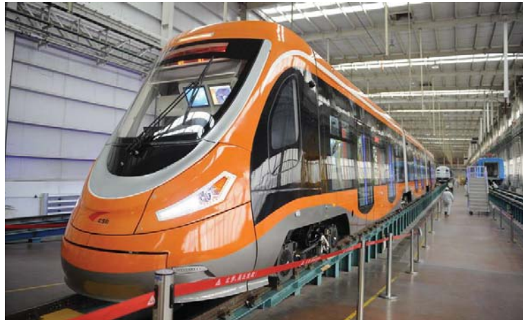
Figur 12: Trikk med brenselcelledrift satt i drift i Kina i 2015 (Alternative Energy, 2015).
