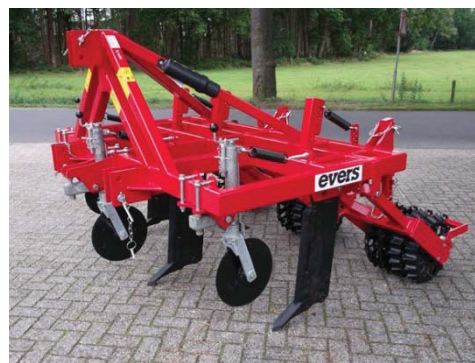
Figur 2.12: Et eksempel på sward lifter med fire løsneaggregater (Bhogal et al. 2011).
