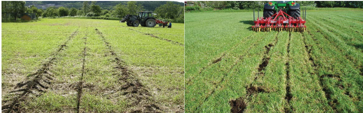
Figur 5.1: Det er forskjell på hvordan jordløsneren etterlater seg jordoverflaten etter kjøring. I bildet til venstre etterlater redskapet en forhøyning på jordoverflaten hvor løsnetinde har gått. Dette er ikke tilfellet i bildet til høyre.
