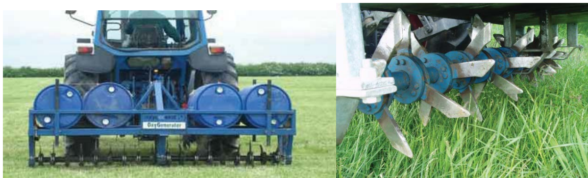
Figur 2.10 t.v.: En aerator er hovedsakelig konstruert for å øke luftgjennomstrømning i jordoverflata av enga og å forbedre infiltrasjonsevnen av vann (Bhogal et al. 2011).
