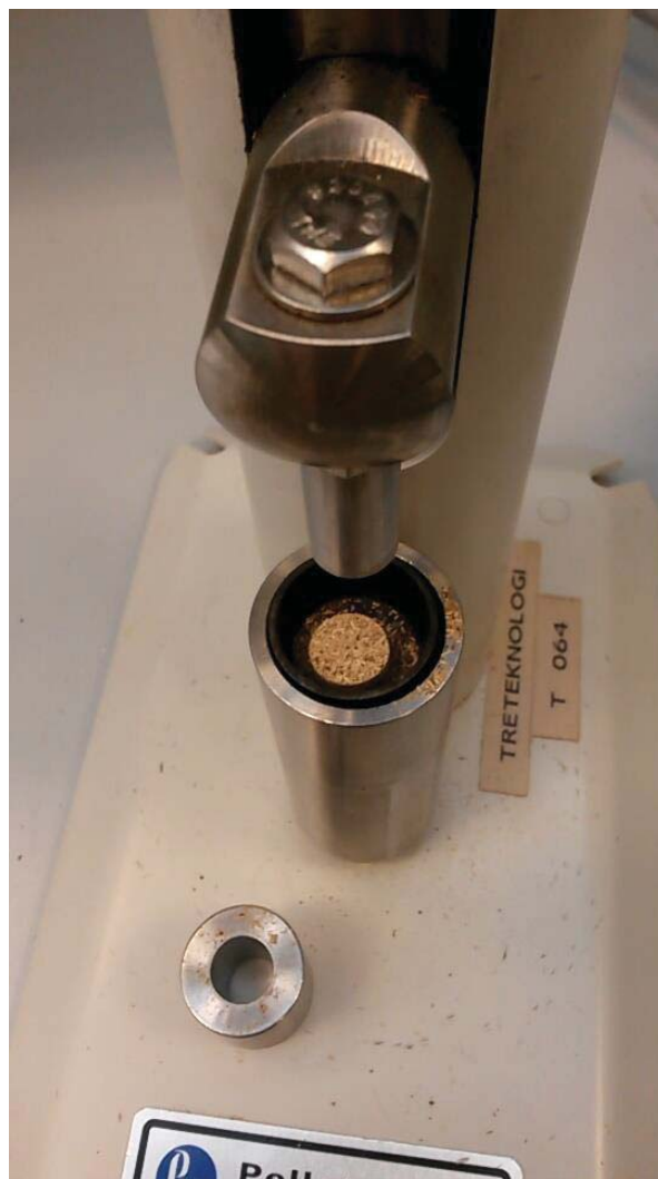
Figur 22: Pelletspress med ferdigpresset pellets (fotografi: kandidaten).
