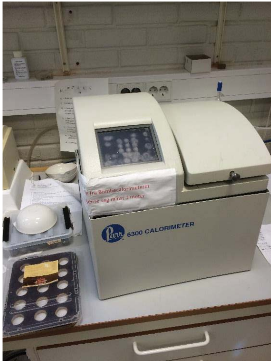
Figur 24: Bombekalorimeteret brukt i forsøkene (fotografi: kandidaten).
