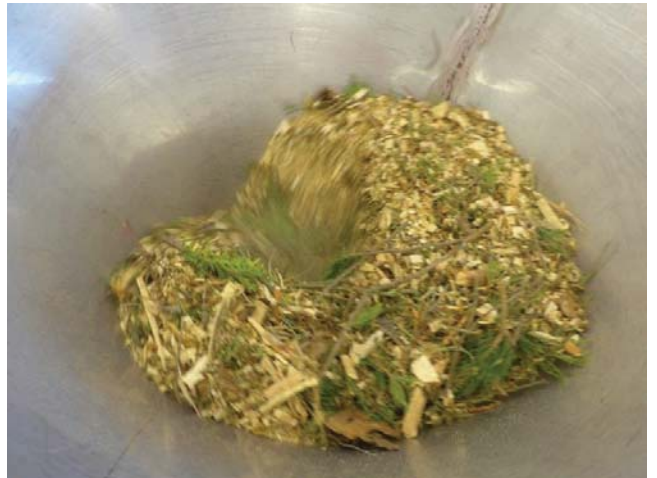
Figur 15: Flisen detter ned i skuffene under når stangen presses inn (fotografi: kandidaten).
