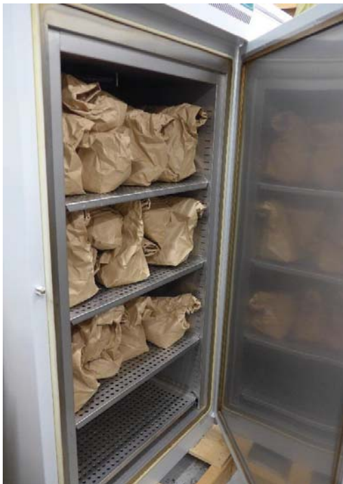
Figur 20: Tørkeskap med fuktprøver (fotografi: kandidaten).
