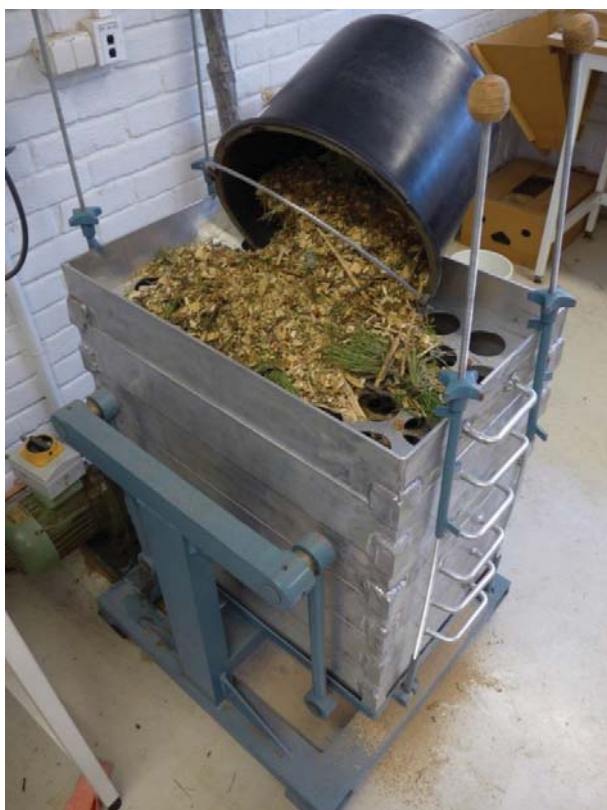
Figur 18: En prøve lagt i soldemaskinen (fotografi: kandidaten).
