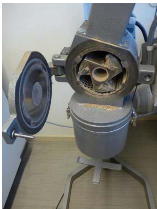
Figur 21: Kvern med 4 mm gitter. Det samles opp mye spon og det er viktig med god rengjøring (fotografi: kandidaten).
