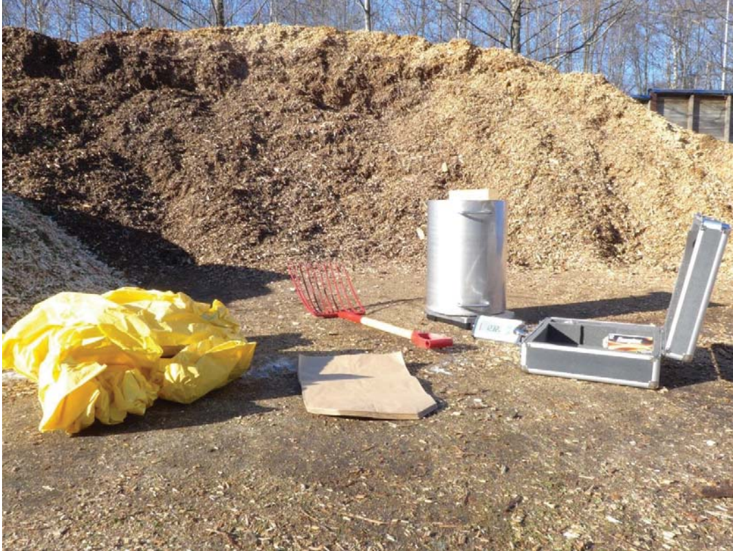
Figur 9: Flishaug hos leverandør. Potetgreip og vekt brukt til bulkdensitetsprøver, plastsekk til 80 l flis brukt til soldeprøver og papirposer til fuktighetsprøver (fotografi: kandidaten).
