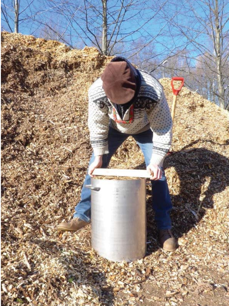
Figur 10: Kandidaten tar bulkdensitetsprøve og flater ut toppen ved bruk av lekt (fotografi: Tara Holm).
