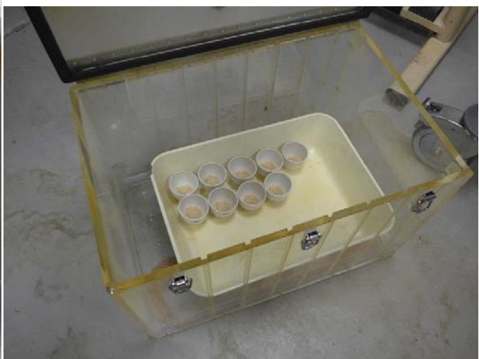
Figur 26: Eksikator med tørkede sponprøver.
