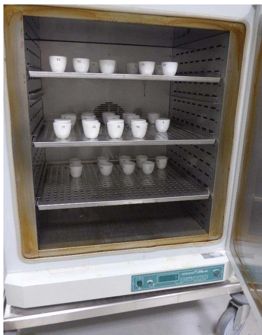
Figur 25: Skåler med fuktighetsprøver brukt til å korrigere bombekalorimeteret (fotografi: kandidaten).
