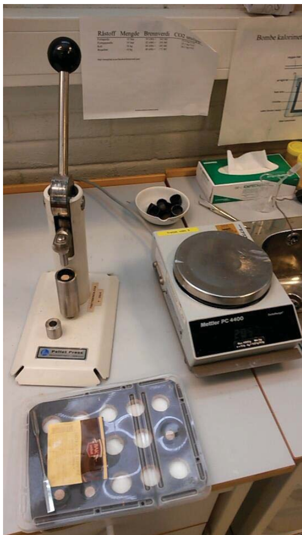
Figur 23: Pelletspress, vekt og brett med nummererte prøver (fotografi: kandidaten).
