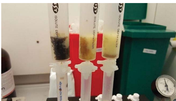
Figur 20: Rensing av ekstraktet med ISOLUTE DEPTH FILTER før Oasis Prime-kolonne. Til venstre er kaliumhydroksid (KOH), i midten tetraborat og til høyre MQ-vann.
