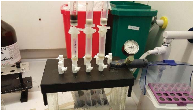
Figur 18: Opprensning med bruk av Strata X-CW kolonne. Til venstre er kaliumhydroksid (KOH), i midten tetraborat, til høyre er det MQ-vann.
