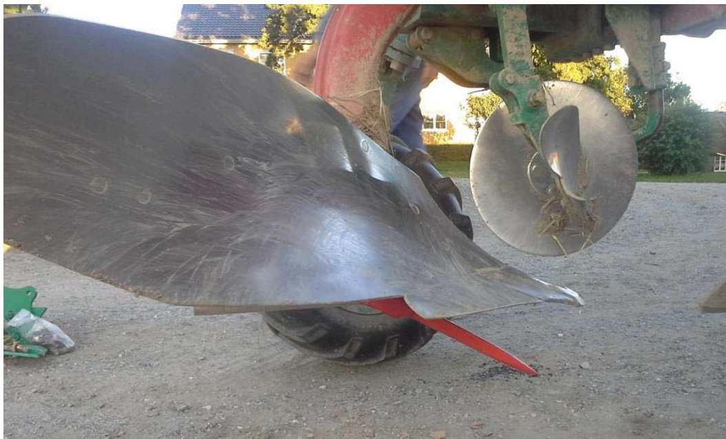
Figur 22 Løsnetinde montert på plog sett fra siden
