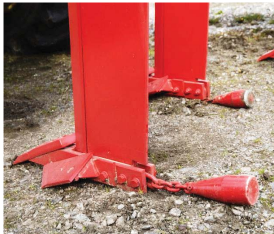
Figur 17 Kverneland CLE løsnetinder med vinger og dreneringskon Foto: Håvard Simonsen
