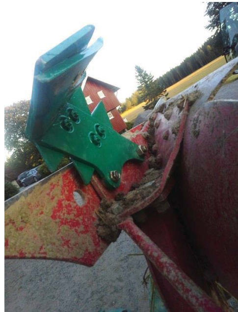
Figur 19 Kverneland Økoskjær montert på plog sett bakfra
