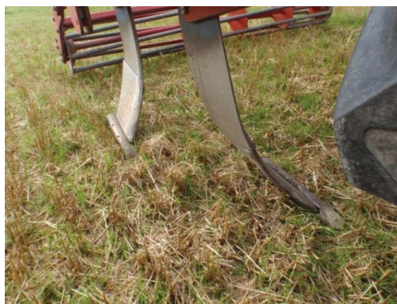
Figur 15 Dal-Bo Ratoon bøyde løsnetinder med torpedo.
