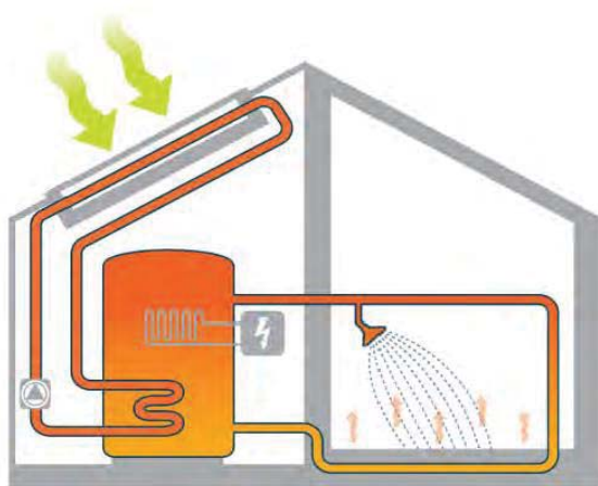
Figur 3.14 Prinsippskissa for solenergianlegg i ein bustad. Kjelde: (Norges vassdrags- og energidirektorat 2008)
