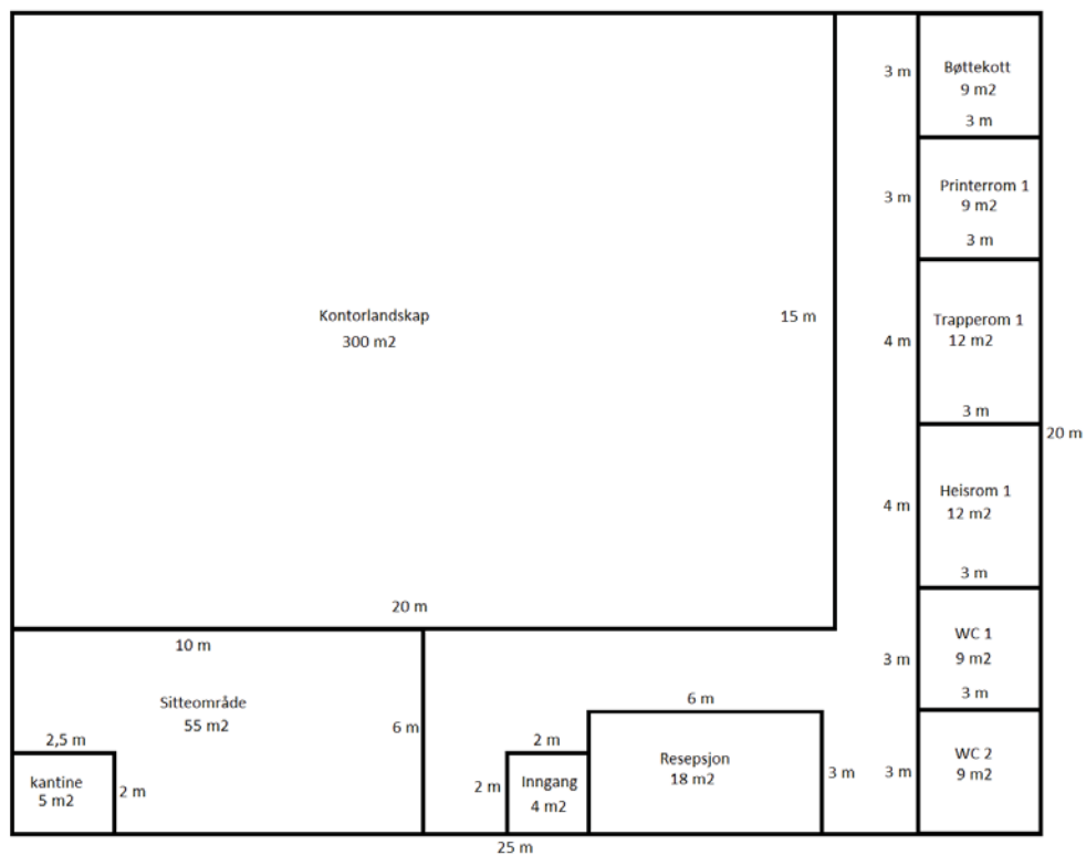
Figur 6.4 Rominndeling brukt i SIMIEN for 1. etasje
