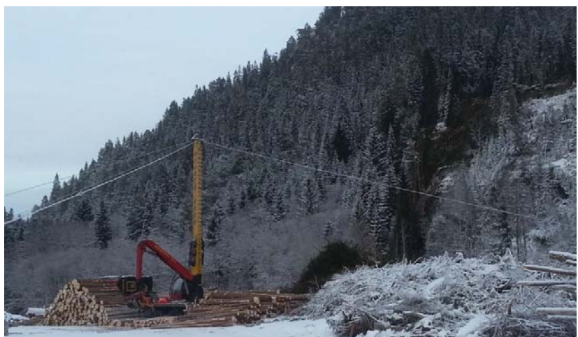
Bilde 1 T. Frivik taubanedrift avvirker svært bratt terreng med en Mounty 4000 kran, i Meldal, Sør-Trøndelag. Foto: Sverre Husby
