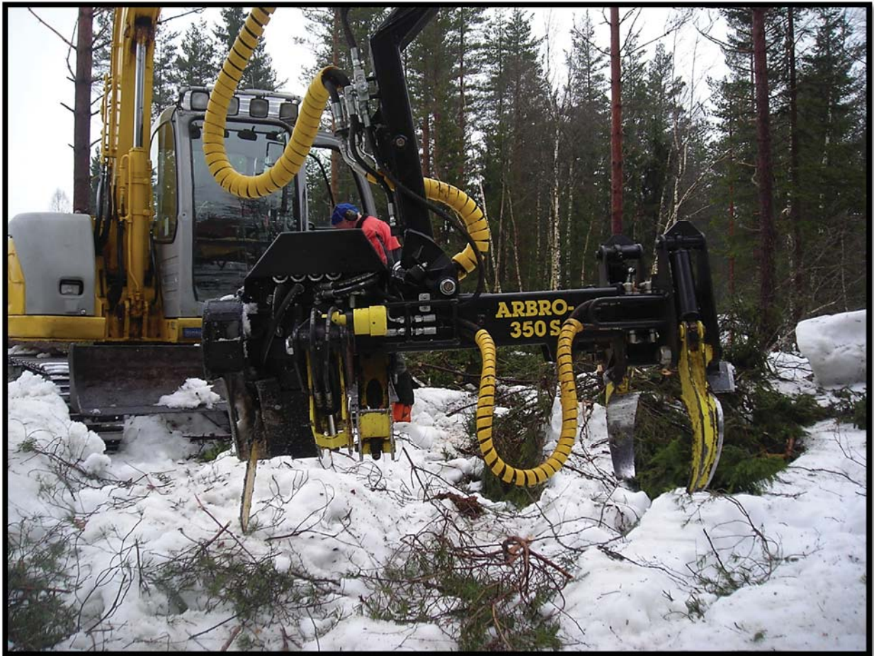
Bilde 12. «Arbro-350 S» hogstaggregat (foto: Tim-Oliver Wenski)
