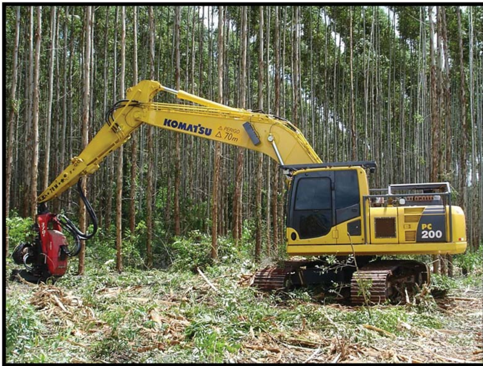
Bilde 4. Den beltegående gravemaskinen «Komatsu PC200F-8» med fabrikkmontert «hogstaggregat-pakke» (komatsuforest.cz)
