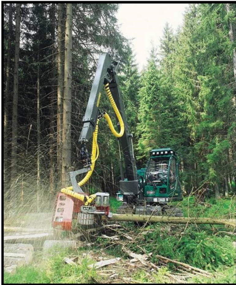
Bilde 2. Den beltegående tynningshogstmaskinen «Neuson Ecotec 9002HV» ( specs.lectura.de )
