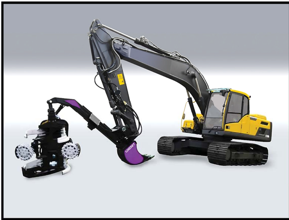
Bilde 5. Beltegående gravemaskin utstyrt med «Logset THXtender» «hogstaggregat-pakke» med skuff (logset.se)
