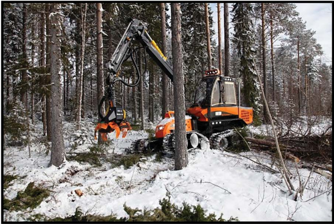
Bilde 3. Den beltegående kombinasjonsmaskinen «Timbear Lightlogg C» (timbear.se (a))
