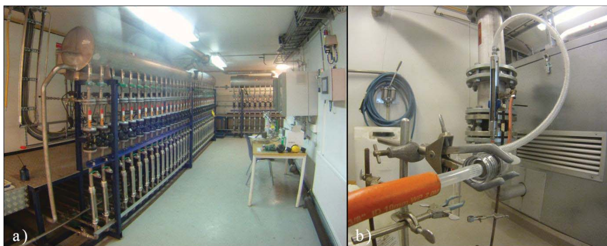
Figur 3.3 a) Oppsamling av gassbrønner til samlestokk i prosessbygget, b) prøveoppsettet med rotameter (bak), kondensrør (delvis skjult), kassett og tilhørende koblinger og slanger.
