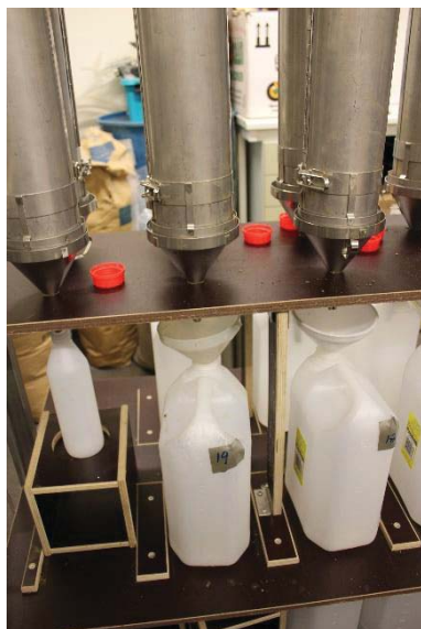
Figur 3.4. Vannkanner som tar imot nedvaskings vannet.
