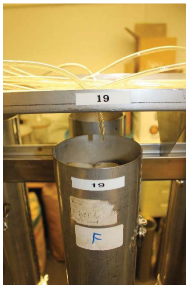
Figur 3.5. Det ligger filter på toppen av jordsølen som tar imot kunstregnet.
