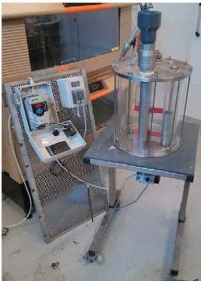
Figur 3.11 – Utråtningstankene benyttet i dette studiet
