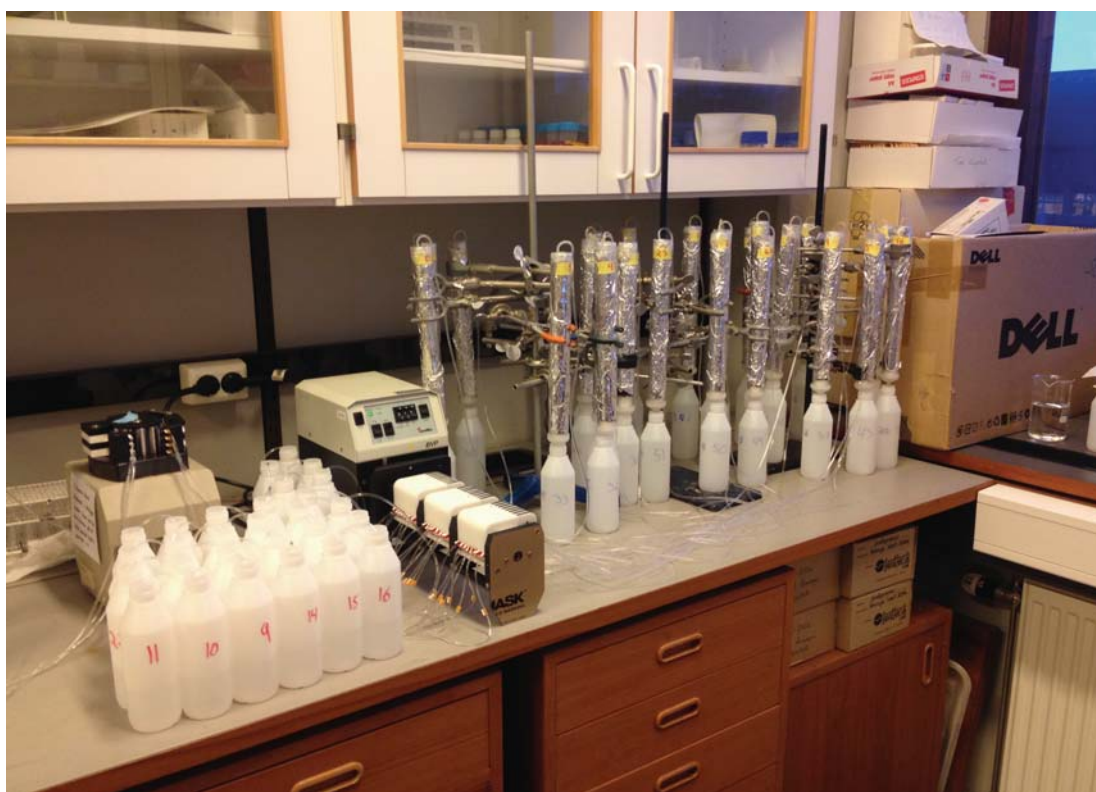
Figur 25: Forsøksoppsett med søylene koblet til en pumpe som pumpet ekstraksjonsvæsken fra flaskene til venstre gjennom slangene og ned i søylen. Flaskene under søylene tok i mot utvasket væske.
