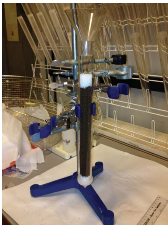
Figur 24: Oppsett på fylling av søyler, med plastkuler over og under jordsøylen.
