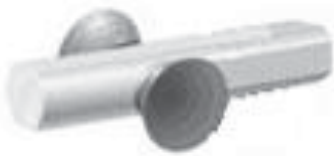
Figur 7 Prinsipp tegning av en reduserer. De store metallhjulene har form som to avkortede kjegler, huggknivene sitter på de koniske sidene. (Foto: http://www.se-saws.no/ )
