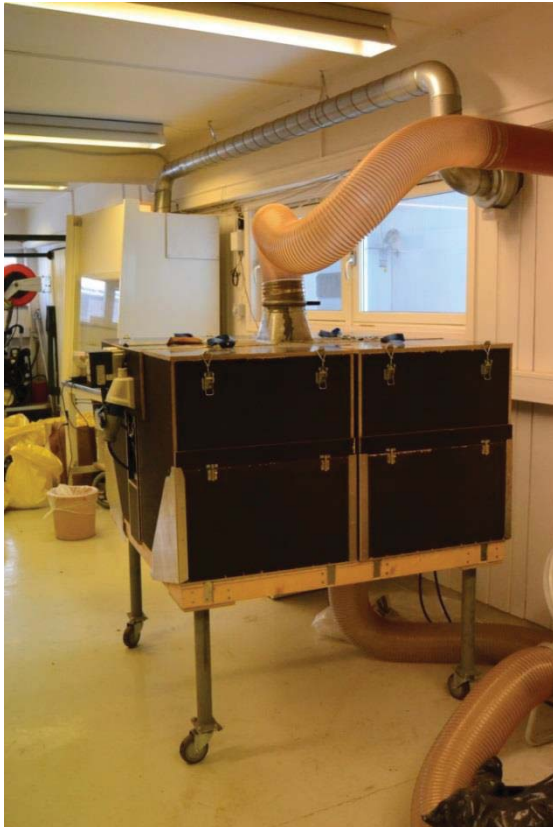
Figur 2.9. Apparat for tørking av sikteprøver. Foto: Thor G. Lie.
