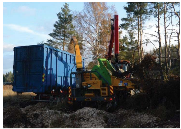
Figur 2.2: Valtra S352 traktor med Heizohack 10-500KT flishogger. Foto: Thor G. Lie
