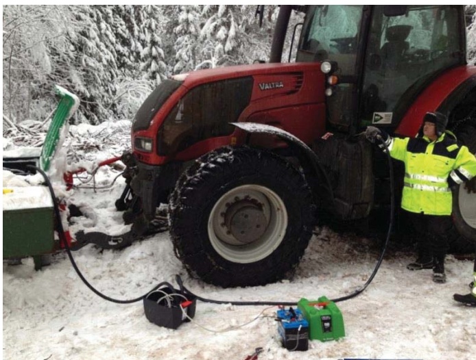
Figur 2.5: Måling av dieselforbruk med elektrisk dieselpumpe. Foto: Thor G. Lie
