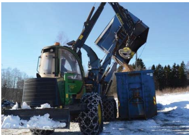
Figur 2.1: John Deere 1510E lassbærer med Bruks 805.2 STC flishogger. Foto: Thor G. Lie
