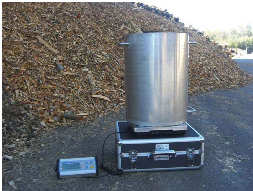
Figur 2.6: Veiing av bulkdensitetprøver. Foto: Eirik Nordhagen.
