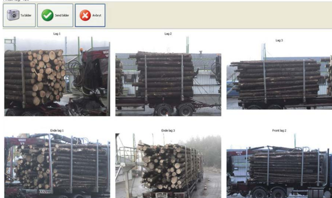
Figur 4: Eksempel på bildeserie av et lastebillass slik det ser ut på sjåførterminalen (Norsk Virkesmåling 2010b).
