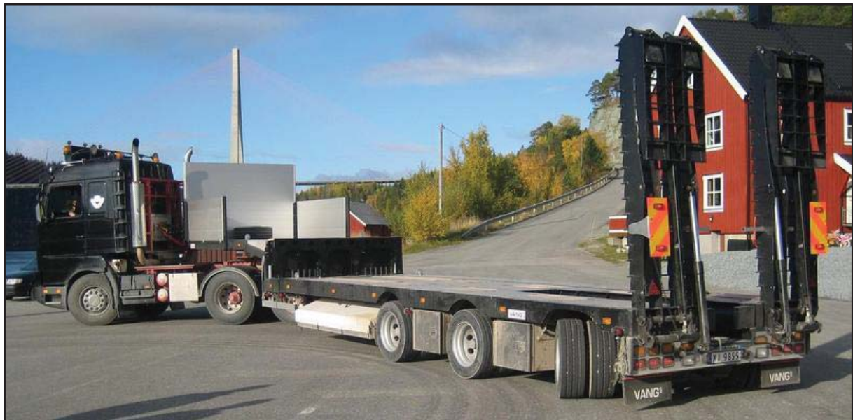
Figur 16: En tilhenger fra Vang hvor den bakerste akselen er medsporende. ( www.vangs.no )
