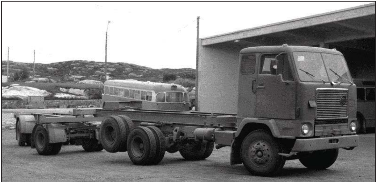
Figur 9: En 6x2 lastebil med boggiløft og tvillinghjul på boggien. ( www.bergiltruckstop.no )
