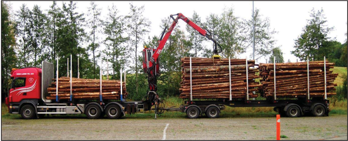
Figur 6: Et 22 meters vogntog som lesser ett lass med massevirke. Sjåføren har ikke problemer med å lesse da han har plass nok på tilhengeren da stokklengden er under 5 meter. Når sjåføren er ferdig med å lesse kan han trekke den bakre bunt fremover på tilhengeren og “stenge igjen” lysåpningen som blir mellom buntene og de bakerste stokkene kommer innenfor ramma på tilhengeren. Dette er for å unngå overheng da bilen skal kjøre på vei for 22 meter tillat totallengde. Foto: Erik Gjerstadberget
