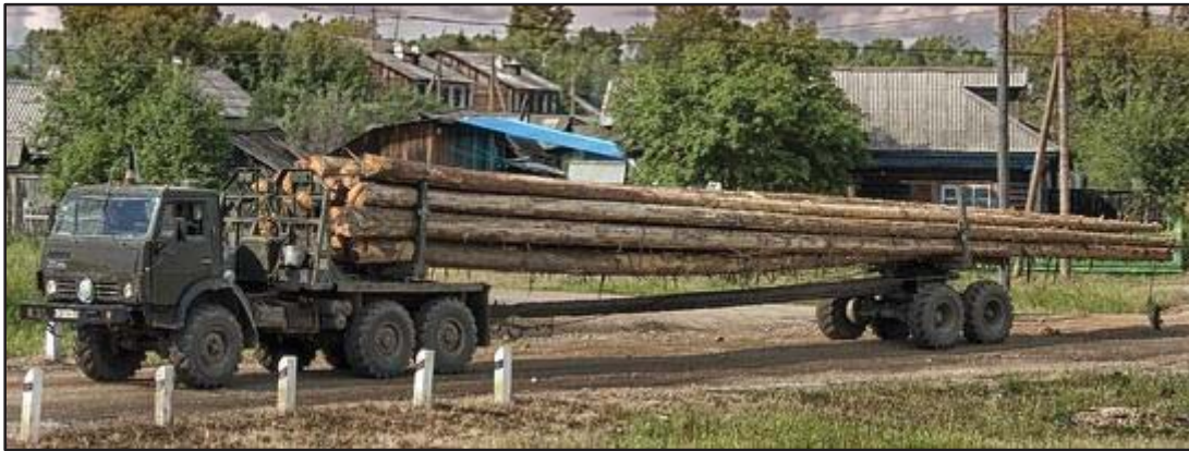
Figur 5: Semitrailer fra Sibir i Russland med langt overheng bak boggien på tilhengeren. Lasten stikker ut bak og øker lengden på kjøretøyet betydelig. (pixabay.com)
