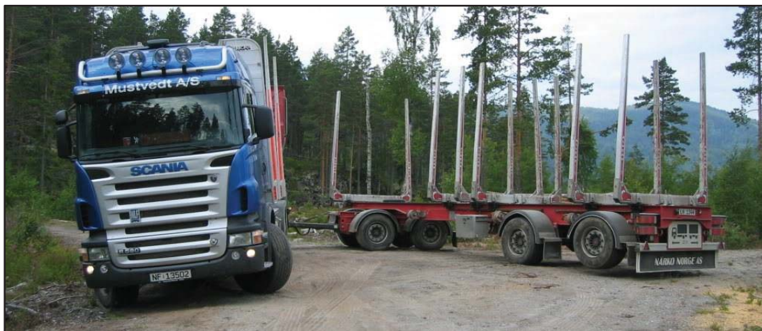
Figur 25: Et 22 meters tømmervogntog med boggiløft på tilhengeren. Vogntoget får betydelig bedre sporingsegenskaper samtidig som boggien bak på tilhengeren ikke skraper opp rundkjøringa. ( www.berglitruckstop.no )
