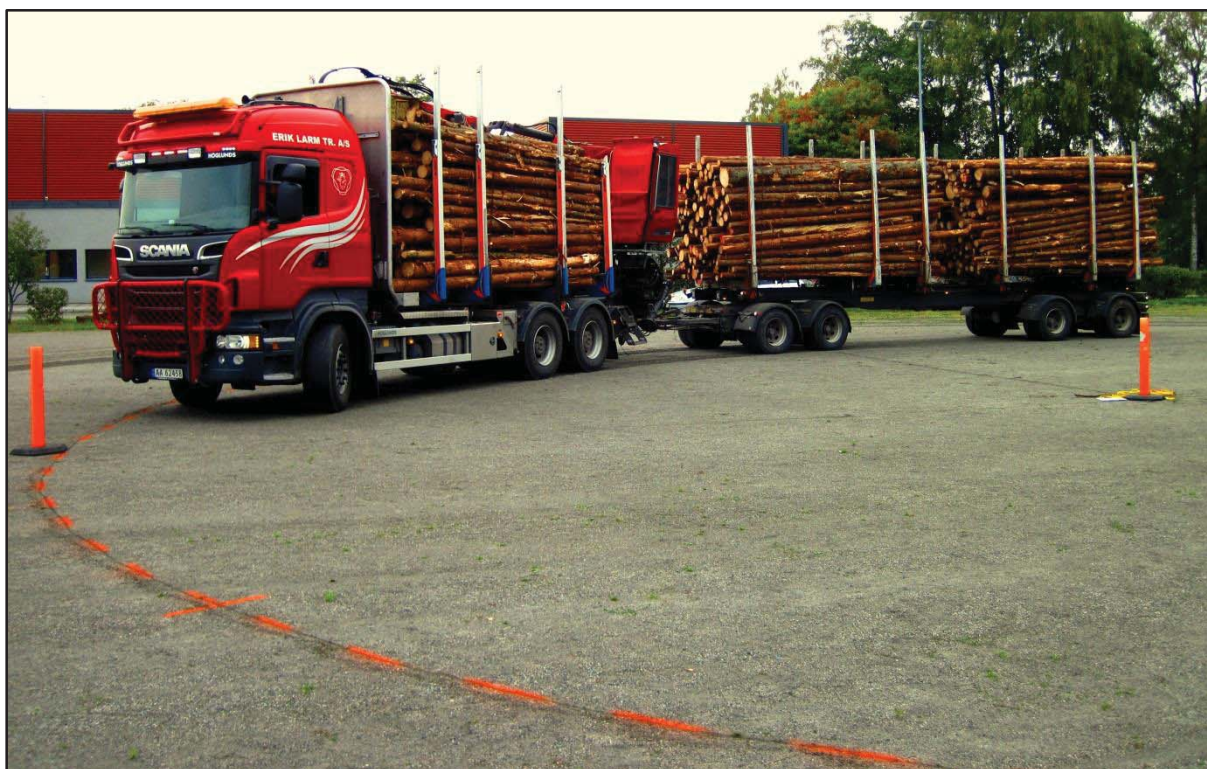
Figur 13: Sporingsforsøk med 22 meters vogntog. Vogntoget kjørte langs den oppmerkede linja som her har en radius på 12 meter. Vogntoget tilhører Erik Larm AS. Foto: Erik Gjerstadberget
