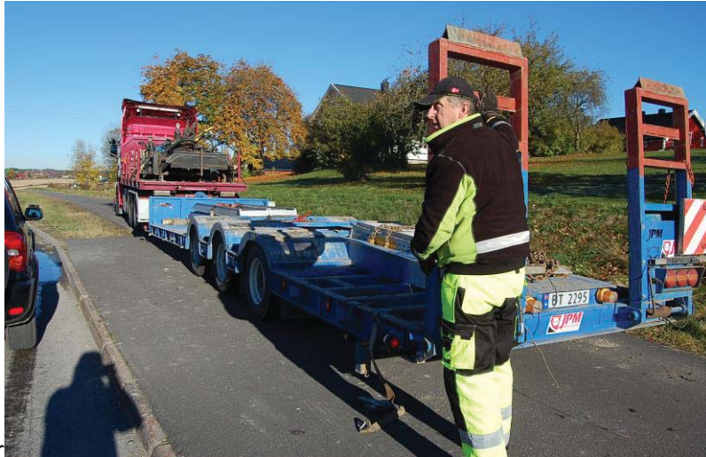
Figur 11. Hogstmaskinen transporteres på denne semihengeren. Utstyret på lastebilen består av hogstaggregat/klippeaggregat, ryddeaggregat
