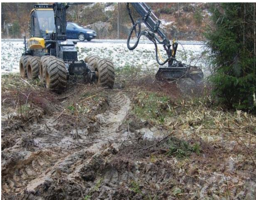
Figur 10. Det var fuktig vær da den maskinelle ryddingen foregikk i Sværsvannfeltet. Hjulspor ca. 30.
