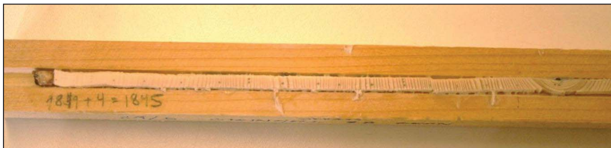
Figur 5: Ferdig oppmontert kjerneprøve, som er slipt, pussa og datert. Foto: Trønnes.
