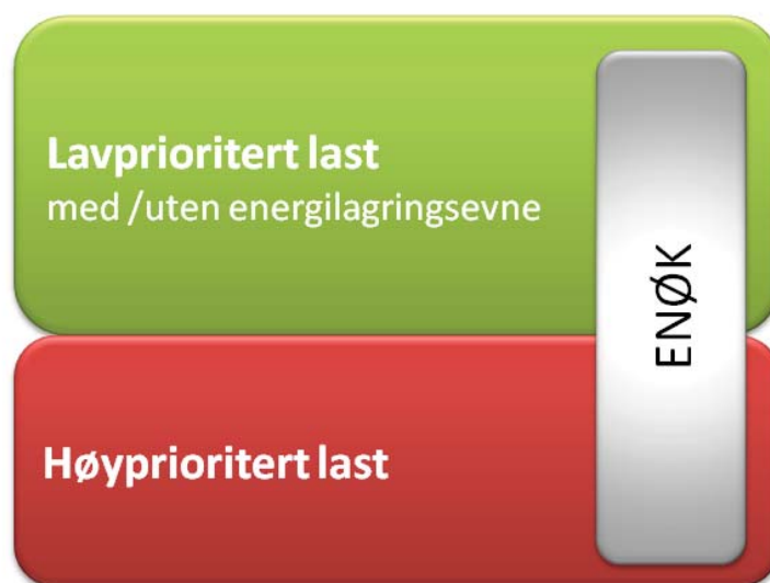
Figur 13 Lastfordeling i en bygning
