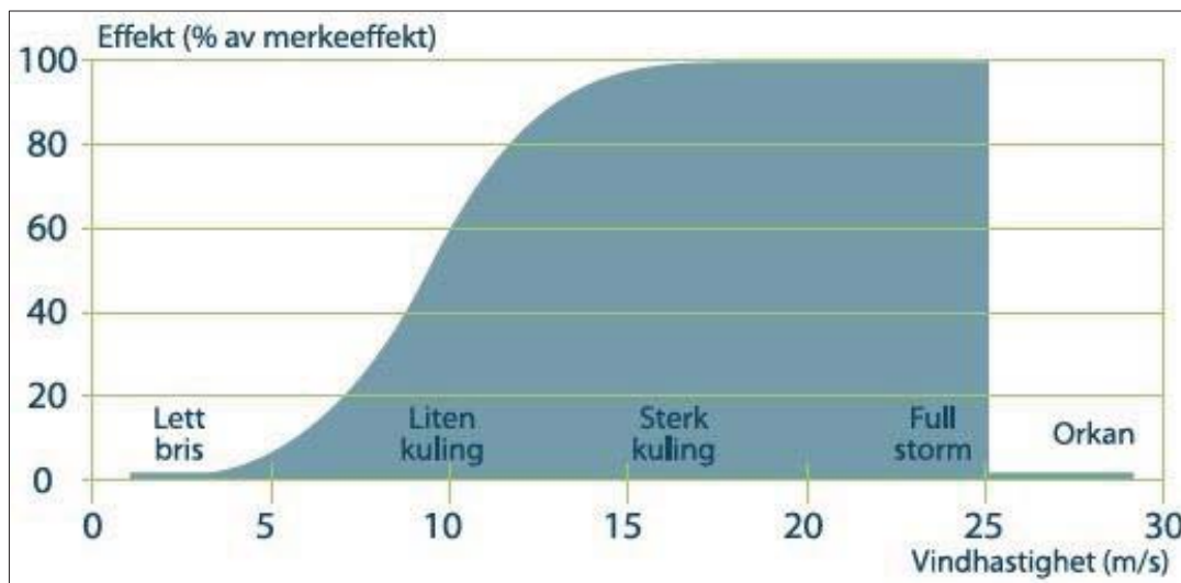
Figur 2: Normalisert effektkurve for en vindturbin
