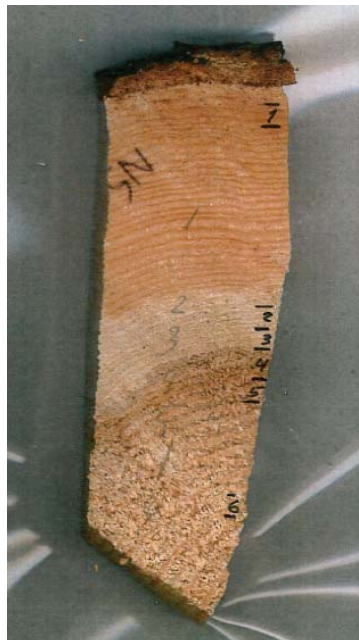
Figur 5. Tallene viser hvor de ulike vedprøvene ble tatt i denne stubbeskiven fra kalkfattigmark (pH 4,16) i Nittedal. 1 viser hvor prøven for SW ble tatt, 2 er hvor prøven for RZ1 ble tatt, 3 er hvor prøven for RZ2 ble tatt, 4 er hvor prøven for DW1 ble tatt, 5 er hvor prøven for DW2 ble tatt, mens 6 er hvor prøven for HW ble tatt. Foto: Ellen Cathrine Burchardt.
