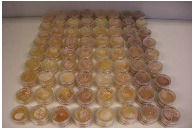
Figur 7. Alle de inokulerte skålene etter en måned i varmeskap ved 21, 5 °C. Den horisontale rekken til venstre består av alle prøvene ifra vedtype 1 (yteved kontroll ifra kalkfattig mark), og kontinuerlig bortover kommer alle vedprøvene hvor vedprøve 8 (reaksjonssoneved ifra kalkrikmark) er lengst til høyre. Foto: Ellen Cathrine Burchardt.
