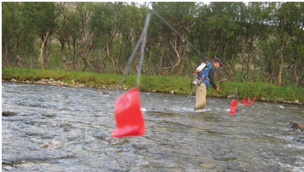
Figur 6. Elektrofiske etter transektmetoden i Veidneselva, med fiske i meterinndelte celler på tvers av elva.
