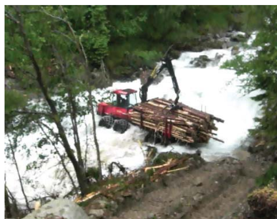
Figur 22: Forsering av elv med tyngre maskiner
