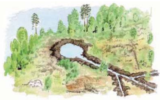
Figur 20: Drenering til eksisterande vassdrag. 24
