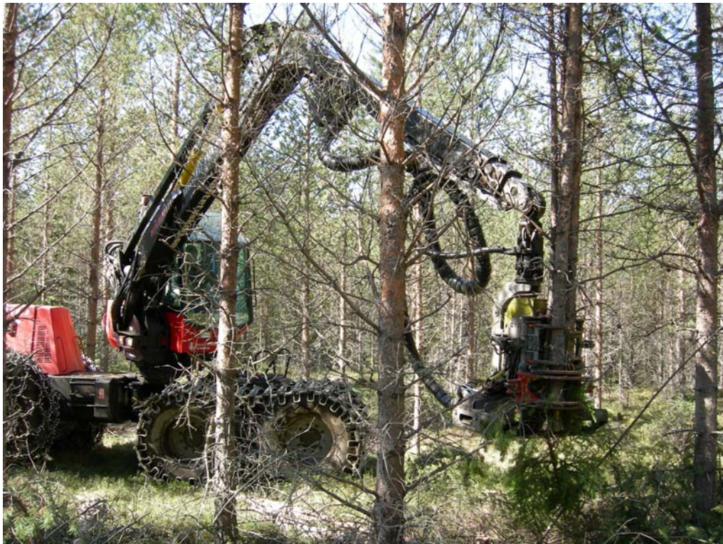
Bilde 1. Tynning av furuskog med Valmet 911 med Bräcke C16.a AFH. (Anders M.E. Hohle. 2007)
