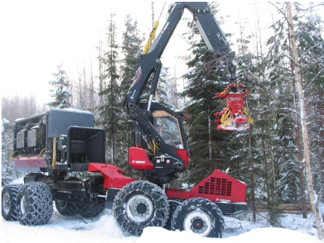
Bilde 3. Valmet 801 Combi med Naarva-Grip AFH og Fixteri buntemaskin. (Laitila. 2008).
