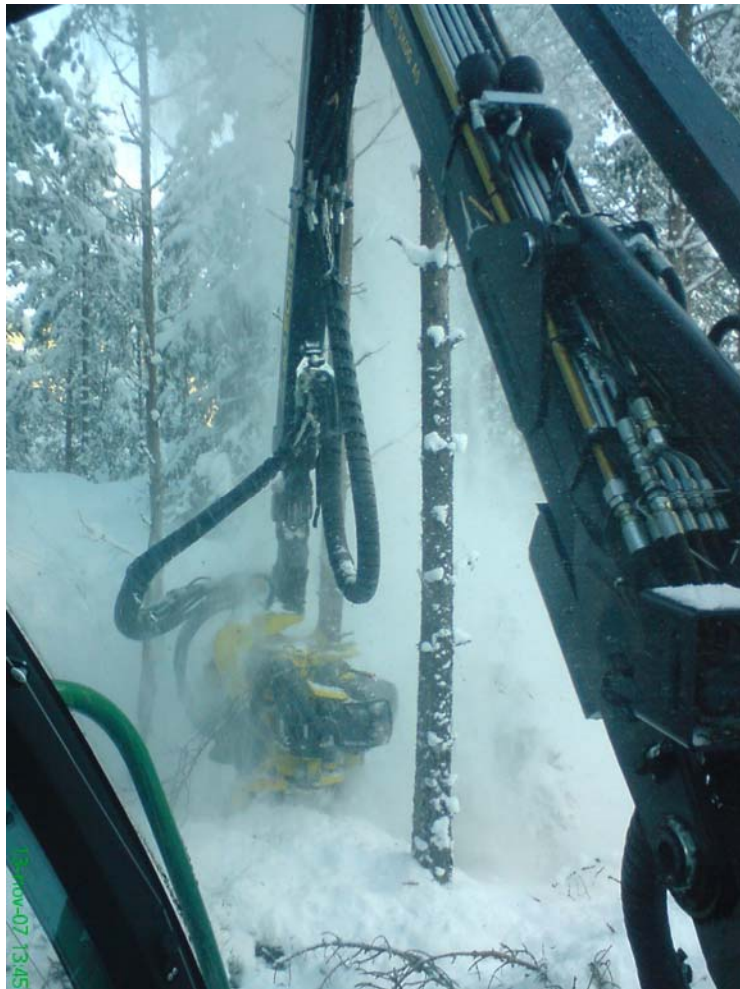
Bilde. Plassering av hogstaggreatet under tynning.
