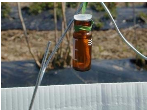
Figur 2-4: Hjemmelaget glassdispenser med polyetylenkork og hyssing som veke. Korken som ble benyttet i forsøkene i Follo er som vist på tegningen til høyre. (Foto: Stuart Gordon, SCRI)
