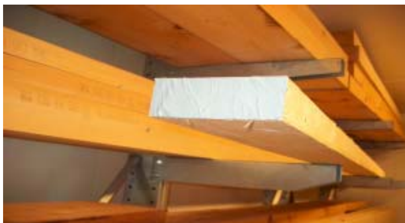
Bilde 4.2.1 Silikonert prøveplank i klimakammer.
