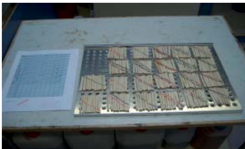
Bilde 4.2.2 Knivdelte prøvebiter klar til tørking, og videre vektmåling.
