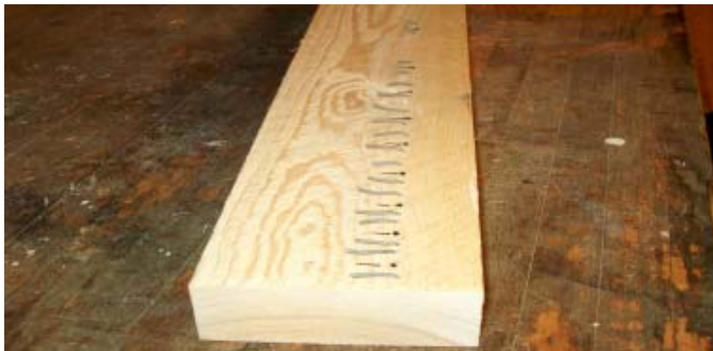
Bilde 4.1.2 Innslagshullene fra resistansmåleren er tettet.
