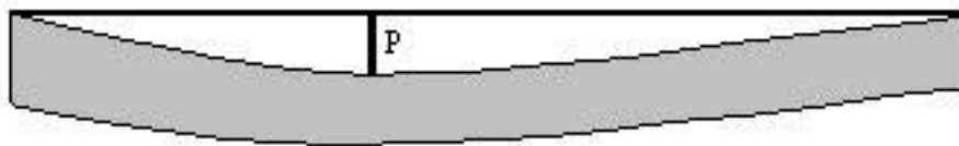
Figur 4. Pilhøgda (P) var målt som største avstand mellom den spente lina og stokkens barkoverflate i retning lina.
