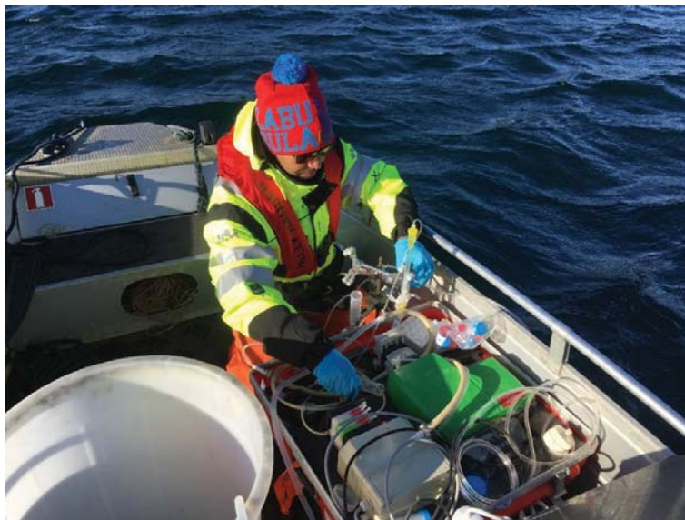
Figur 8 In situ fraksjonering av vann i Kaldvellfjorden (foto H.C. Teien)
