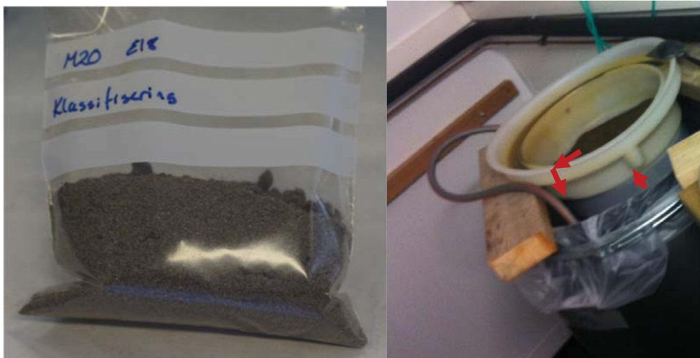
Figur 3 Knust gneis og design av utlekkingstest på laboratoriet NMBU. Piler indikerer sirkulasjon av vannet (foto H.C. Teien)
