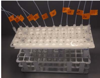
Figur 3. Forsøksoppsett for oppstraums kolonnetest. Forsøket simulerer tilhøve i eit biofilter. Ei peristaltisk pumpe gav ein konstant gjennomstrøymingshastighet i forsøket på 2 mL/min. Forsøket varte i ei veke. Leiingsevna i bufferløysinga var 5,3 mS/cm mot 1,0 \mu S/cm i ionefritt vatn.
