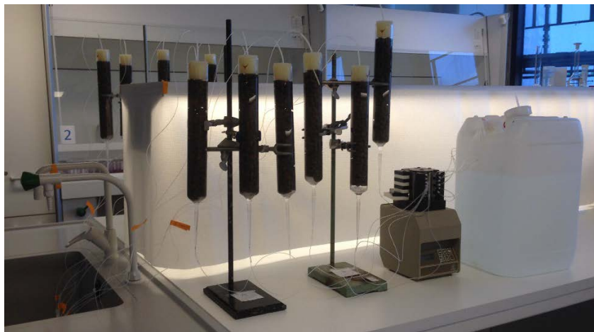
Figur 3. Forsøksoppsett for oppstraums kolonnetest. Forsøket simulerer tilhøve i eit biofilter. Ei peristaltisk pumpe gav ein konstant gjennomstrøymingshastighet i forsøket på 2 mL/min. Forsøket varte i ei veke. Leiingsevna i bufferløysinga var 5,3 mS/cm mot 1,0 \mu S/cm i ionefritt vatn.
